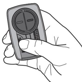
**2** Ouvrir la télécommande. Tenir enfoncé le bouton de programmation jusqu'à ce que la DEL s'allume (environ deux seconds).
