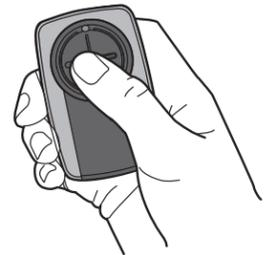
La DEL de la télécommande universelle DOIT cesser de clignoter entre chaque pression exercée sur le bouton. Le code est accepté lorsqu'un déclic ou un bip retentit, qu'une lampe clignote ou que la porte/le portail s'actionne.
